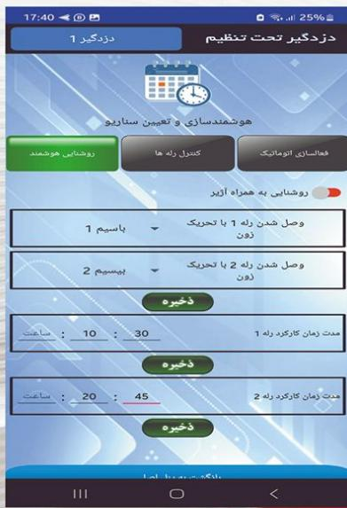
\* قابلیت روشنایی به همراه آژیر به این صورت عمل میکند که همزمان با شروع آژیر(به علت تحریک هر کدام از زونهای بیسیم و باسیم) رله 2 دستگاه نیز روشن و همزمان با تمام تایم و خاموش شدن آژیر رله 2 نیز خاموش میشود: **A821** روشنایی به همراه آژیر فعال :
